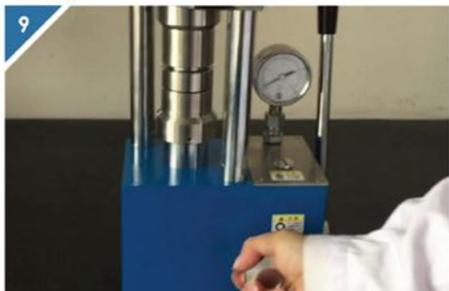
9 逆时针松开放油阀释放压力并把模具降回初始位置。
