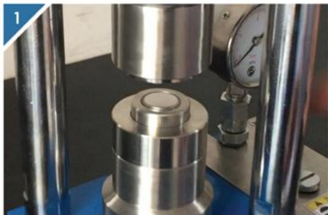
1 将组装好的纽扣电池放到封口机的封口模具中。
