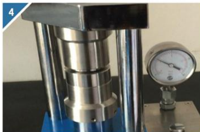
4 将压力压倒6mpa-8mpa左右，约1000kg-1200kg。
