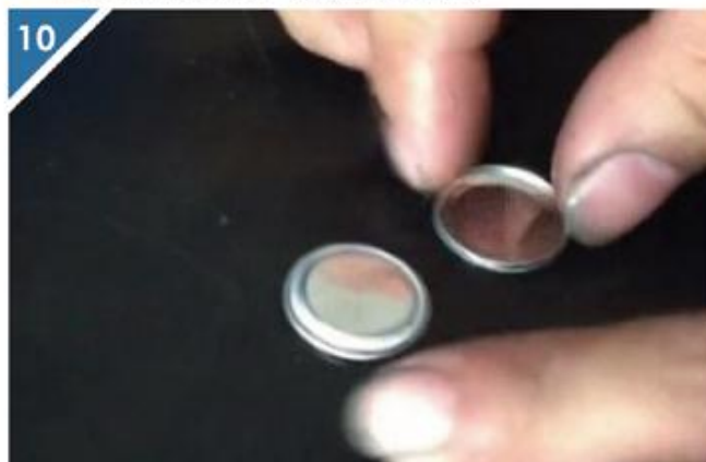
10 从封口机中取出已经分离的纽扣电池。
