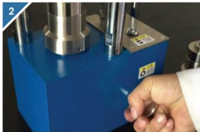
2 顺时针拧紧封口机放油阀。
