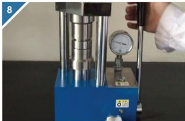
8 将压力压倒2mpa-5mpa左右，将封好的纽扣电池分离。
