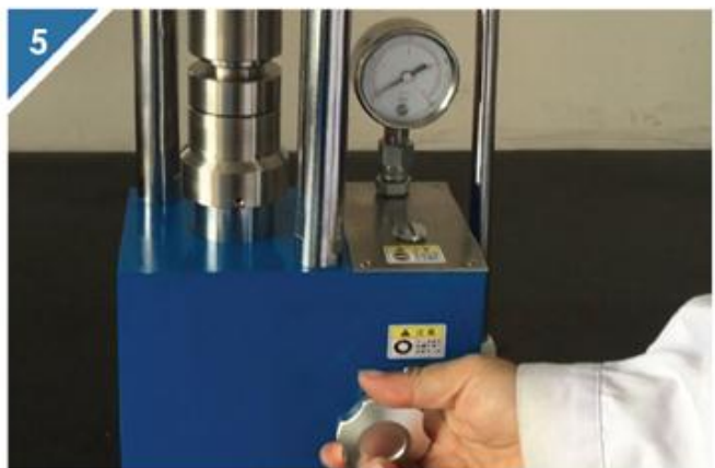
5 逆时针松开放油阀释放压力并把模具降回初始位置。
