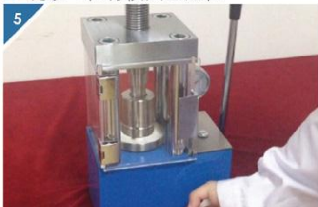
5 逆时针松开放油阀释放压力
