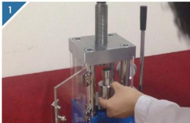
1 将模具放置在压片机中心位置
