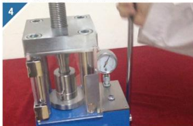
4 前后摇动手柄压杆达到所需压力
