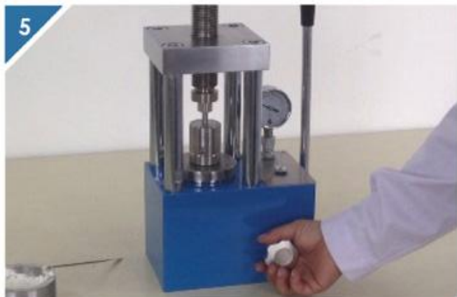
5 逆时针松开放油阀释放压力
