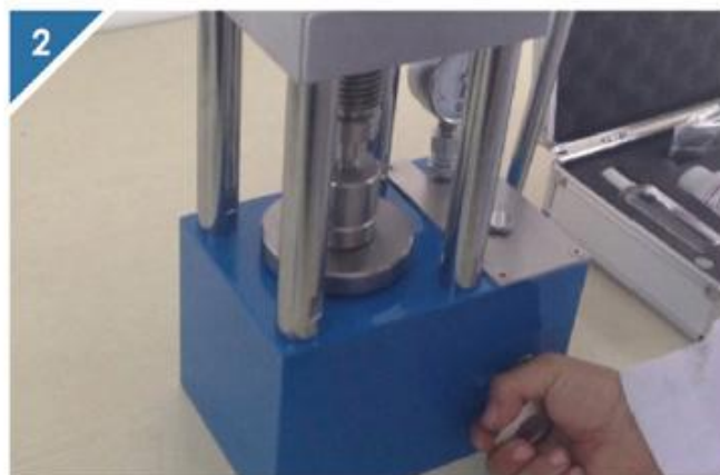
2 顺时针拧紧压片机放油阀
