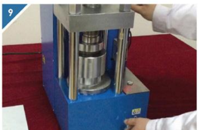
9 按下绿色启动按钮，将压片机的电源关闭，然后松开放油阀杆，将压力释放为0。
