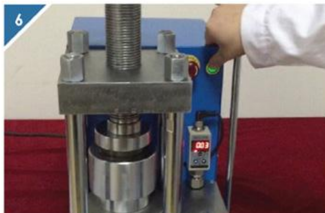
6 按下绿色的启动按钮，压片机开始加压，加到所设定的压力后，系统自动停机。
