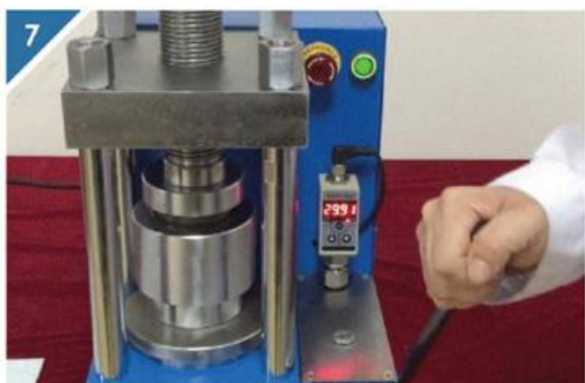
7 如果需要精确控制压力，可以通过右侧手动加压装置，将压片精确控制到所需压力。
