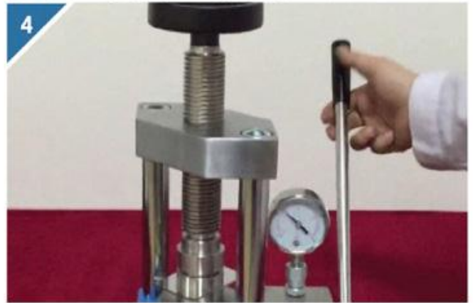
4 前后摇动手柄压杆达到所需压力
