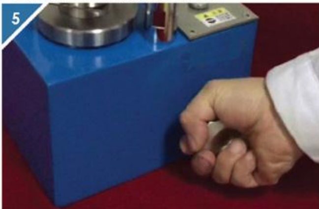
5 逆时针松开放油阀释放压力
