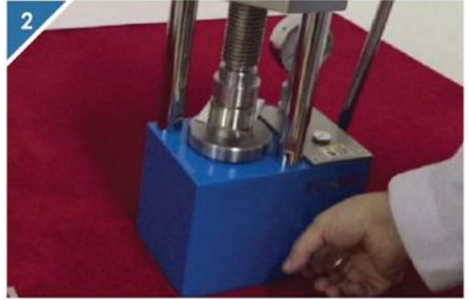
2 顺时针拧紧压片机放油阀
