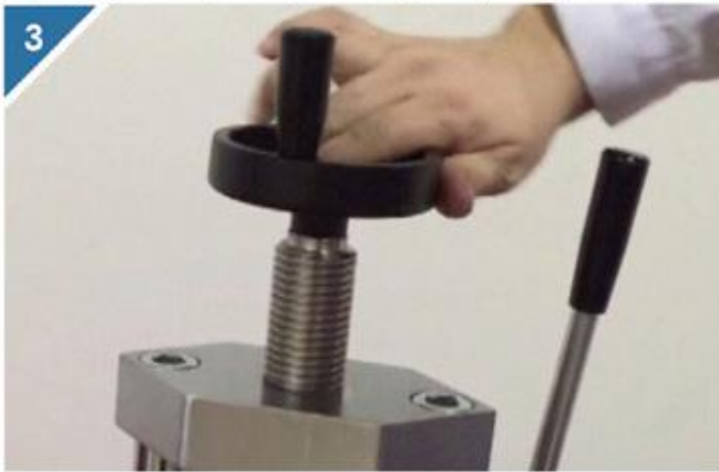
3 旋紧丝杠将模具固定住
